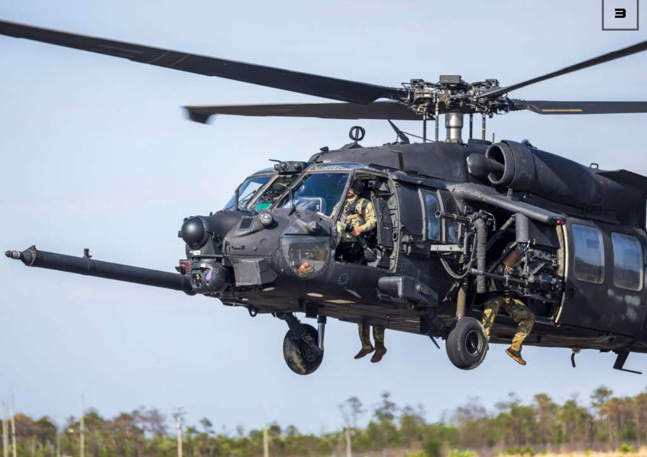
O Black Hawk MH-60M D.A.P. (Direct Action Penetrator) é uma variante do MH60 de Operações especiais do Exército Americano, que para além de toda a panóplia de equipamentos que estas aeronaves já levam, ainda possuí umas pequenas asas fabricadas pela *Fulcrum Concepts LLC* que lhe permitem levar armamento pesado de ataque ao solo.
